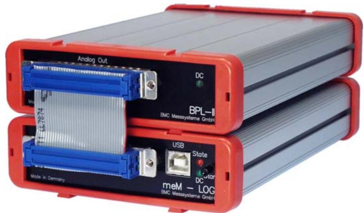
Durch die 5V-Hilfsspannung, die der Logger an Pin 17 der 37-pol. Sub-D Buchse zur Verfügung stellt, wird die *BP16* über den **meM-LOG-SE** mit Strom versorgt und ein- und ausgeschaltet.
