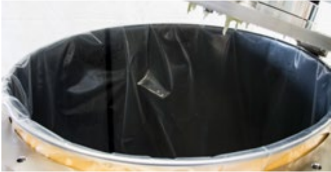
Vakuumpannfass mit Inliner vor dem Einschalten der Vakuumpumpe Vacuum drum with Inliner before switch-on of the vacuum pump
