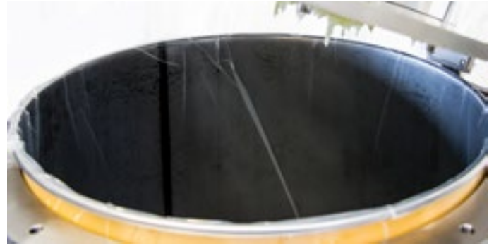
Inliner liegt durch hergestelltes Vakuum an dem Fass an Due to generated vacuum the inliner fits closely to the drum
