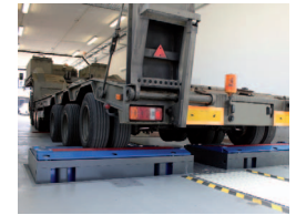
Fahrzeuge mit einer Überbreite von bis zu 3,60 m können problemlos geprüft werden. Abgebildetes Fahrzeug mit 3,20 m auf anhebbarer Rollensatz.
