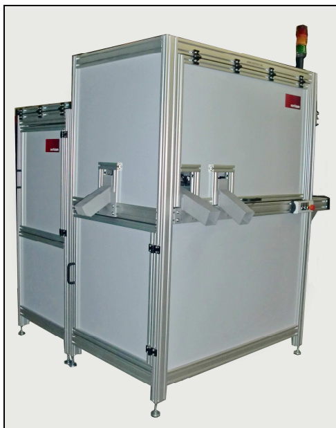
sorticon GT - Glastellerprüfanlage für Scheiben, Müttern, etc. (Fotos: sorticon)
