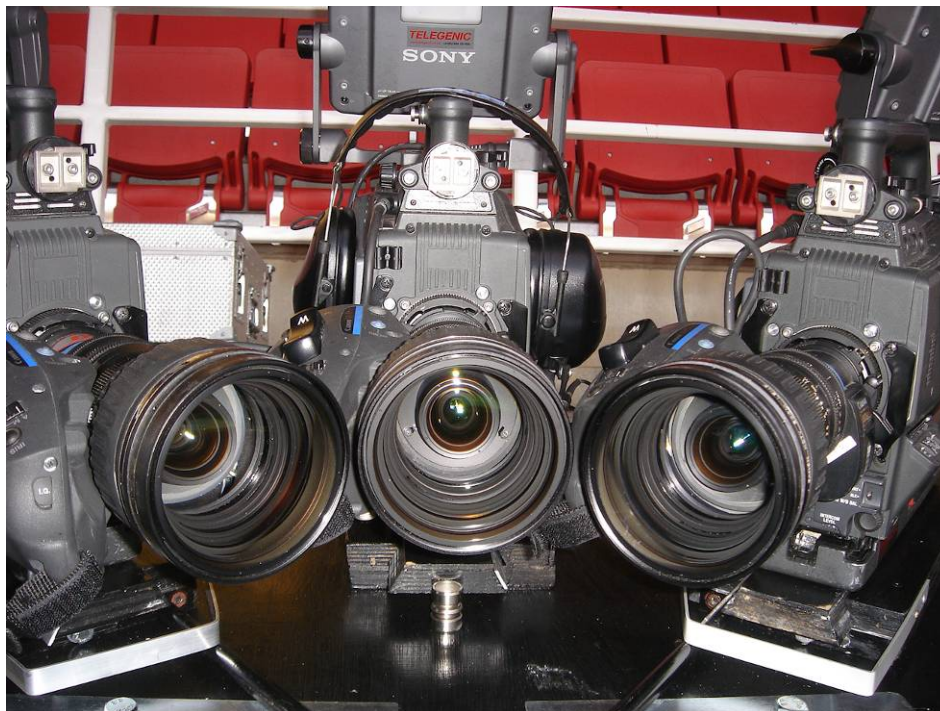
Bild 1: Picture-Stitching: Die Aufnahmen einer zentral positionierten Kameragruppe werden zu einer Gesamtansicht des Spielfelds in HD zusammengeführt.
