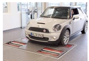
Prüfinstrument ist der Achsdämpfungsprüfstand, Reisacher erhielt den Achsdämpfungsprüfstand MSD 3000. Zusätzlich sinnvolle Einrichtungen sind ein Scheinwerfereinstellgerät und nicht zuletzt die Hebebühne, bei Reisacher stehen hier eine Scheinwerfereinstellgerät LITE 3 und 4 Zwei-Stempel-Hebebühnen von MAHA zur Verfügung.
