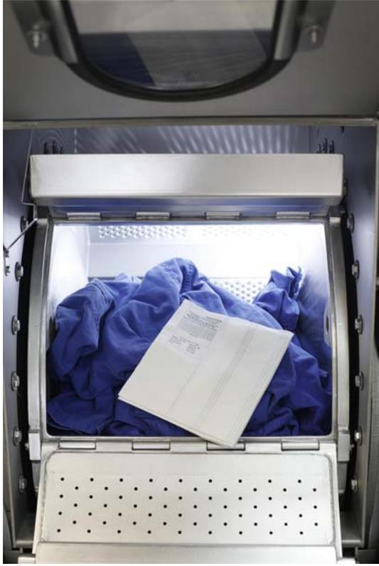
Das Testmaterial durchläuft den Wiederaufbereitungsprozess über eine definierte Zyklenzahl. So werden an den Hohenstein Instituten verschiedene Qualitätskriterien unabhängig und neutral begutachtet.
