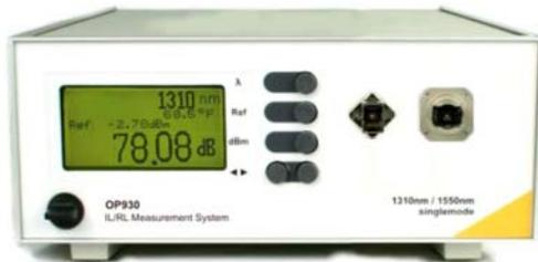
Optische Patchkabel werden heute in großen Stückzahlen produziert und eingebaut. Ob Singlemode oder Multimode: Sie müssen mit den unterschiedlichsten Steckern bezüglich ihrer Einfügedämpfung und Rückflussdämpfung vermessen werden um gute Qualität und einen sicheren Betrieb im Systemeinsatz gewährleisten zu können.
