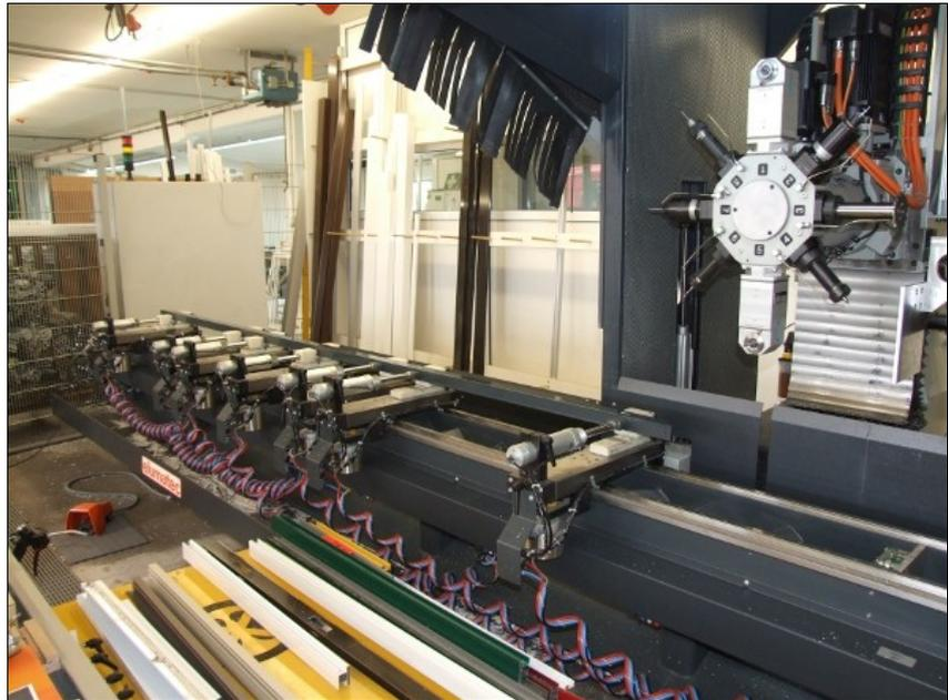
Der Revolverkopf mit 8 Werkzeugen ermöglicht schnelle Werkzeugwechsel und kurze Bearbeitungszyklen.
