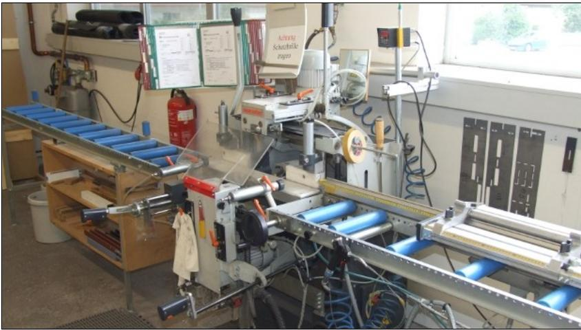
Mehrachsige Stabbearbeitungszentren können gleich mehrere Kleinmaschinen wie z.B. die Kopierfräse ersetzen.
