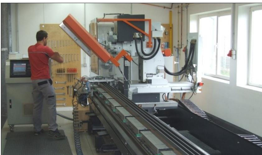
Bearbeitung der Laufschienen am zweiten 3-Achs-Stabbearbeitungszentrum SBZ 130 von elumatec.
