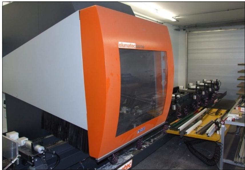
3-Achs-Stabbearbeitungszentrum SBZ 130 von elumatec. Gearbeitet wird in einer Aufspannung am ruhenden Profil.
