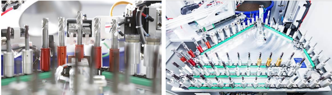
Automatischer Werkstückwechsel mittels Kettenlader
