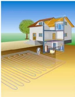
Sole/Wasser-Wärmepumpe mit Erdkollektoren: Kollektoren arbeiten mit einem waagrecht verlegten großflächigen Rohrsystem, das unter der Frostgrenze verlegt wird – in der Praxis bedeutet das eine Tiefe von rund 1 bis 1,5 Metern. Dafür benötigen Kollektoren je nach gewünschter Wärmeleistung rund 200 bis 250 Quadratmeter Fläche für ein Einfamilienhaus.
