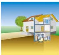
Luft/Wasser-Wärmepumpe: Außenluft als Wärmequelle kann extrem einfach und nahezu überall erschlossen werden, außerdem sind Luft/Wasser-Wärmepumpen vergleichsweise günstig. Daher erfreuen sie sich zunehmender Beliebtheit. Luftwärmepumpen sind etwas weniger effizient als erdgekoppelte Systeme, da die Temperatur der Wärmequelle im Winter recht niedrig ist.
