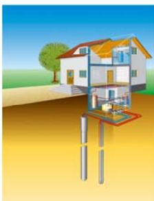
Sole/Wasser-Wärmepumpe mit Erdsonde: Das Erdreich ist das ganze Jahr über eine Wärmequelle mit hoher Wärmeleistung. Ab einer Tiefe von etwa 10 Metern liegt die Temperatur konstant bei rund 10 Grad. Eine vertikale Erdwärmesonde nutzt diese Erdwärme effektiv und ist wegen des geringen Platzbedarfs insbesondere für kleine Grundstücke oder bereits angelegte Gärten empfehlenswert.
