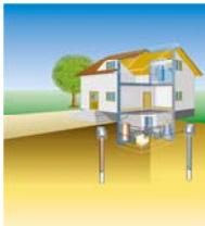
Wasser/Wasser-Wärmepumpe: Wenn Grundwasser in ausreichender Menge, Temperatur, Qualität und in einer möglichst geringen Tiefe vorhanden ist, kann man dieses mit einer Wasser/Wasser-Wärmepumpe sehr wirtschaftlich nutzen. Das Wasser wird über einen Förderbrunnen hoch gepumpt, die Wärmepumpe entzieht ihm Wärme und anschließend wird das Wasser über einen Schluckbrunnen wieder in das Grundwasser eingeleitet.
