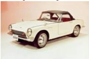
Einheiten des T 360 produziert. Kurze Zeit später (1963) folgt der 44 PS starke und 130 km/h schnelle S500. Der Antrieb erfolgt über eine Kette auf die Hinterachse. Mit ihm trifft Honda in Japan den Nerv der Zeit: Ein kleiner, zweisitziger
