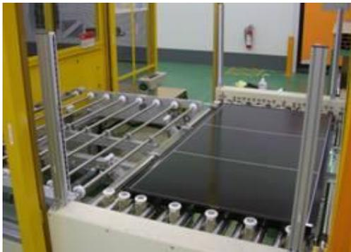
umweltschonender gestaltet werden. Die neueste Generation der Solarzellen wird mithilfe eines aus Kupfer, Indium, Gallium und Selen bestehenden Dünnschichtfilms hergestellt. Im Vergleich zur Produktion herkömmlicher Zellen aus Siliziumkristallen erreicht Honda bei dieser Form der Herstellung einen um 50 Prozent geringeren Energieverbrauch. Durch diese erhebliche Reduzierung des bei der Produktion
