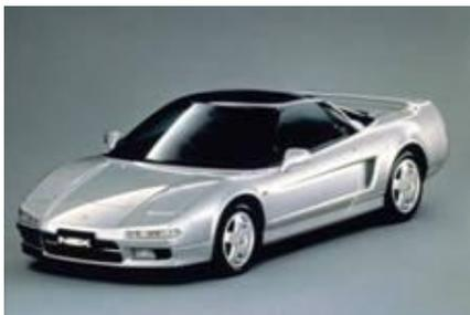
Im Jahr 1990 präsentiert Honda mit dem High-Tech-Sportwagen **NSX** (New Sports eXperimental) das erste Vollaluminium-Serienfahrzeug der Welt. Neben seiner Karosserie wird auch die Radaufhängung aus hochfestem Aluminium gefertigt – eine Gewichtersparnis von 210 kg im Vergleich zu einer Stahlkarosserie. Der V6-3,0-DOHC-VTEC®-
