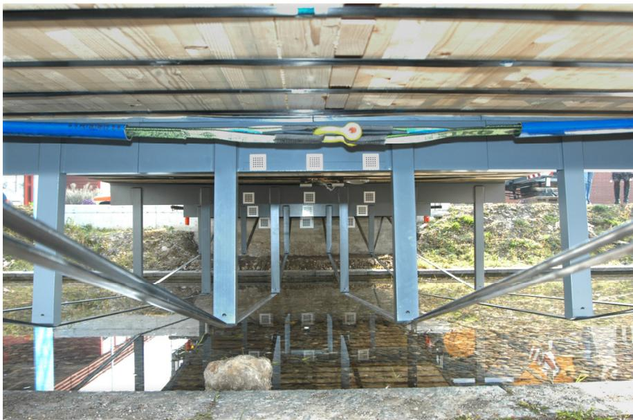
Verformungsmessungen mit einem Videosystem an einer Brettschicht-Holzbrücke, die mit an der Empa entwickelten Zugbändern aus kohlenstofffaserverstärktem Kunststoff (CFK) unterspannt ist.
