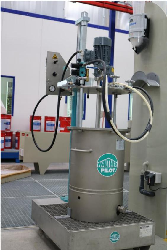
Die Materialdruckgefäßlackieranlage von Walther Pilot gewährleistet optisch hervorragende Oberfläche z.B. bei anspruchsvollen Glasbeschichtungen.
