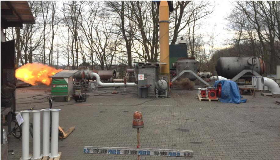
Rückschlagklappen müssen jetzt eine strengere Prüfnorm (EN 16447) erfüllen. Die neue ProFlap III-Baureihe von Keller Lufttechnik meisterte die Tests erfolgreich
