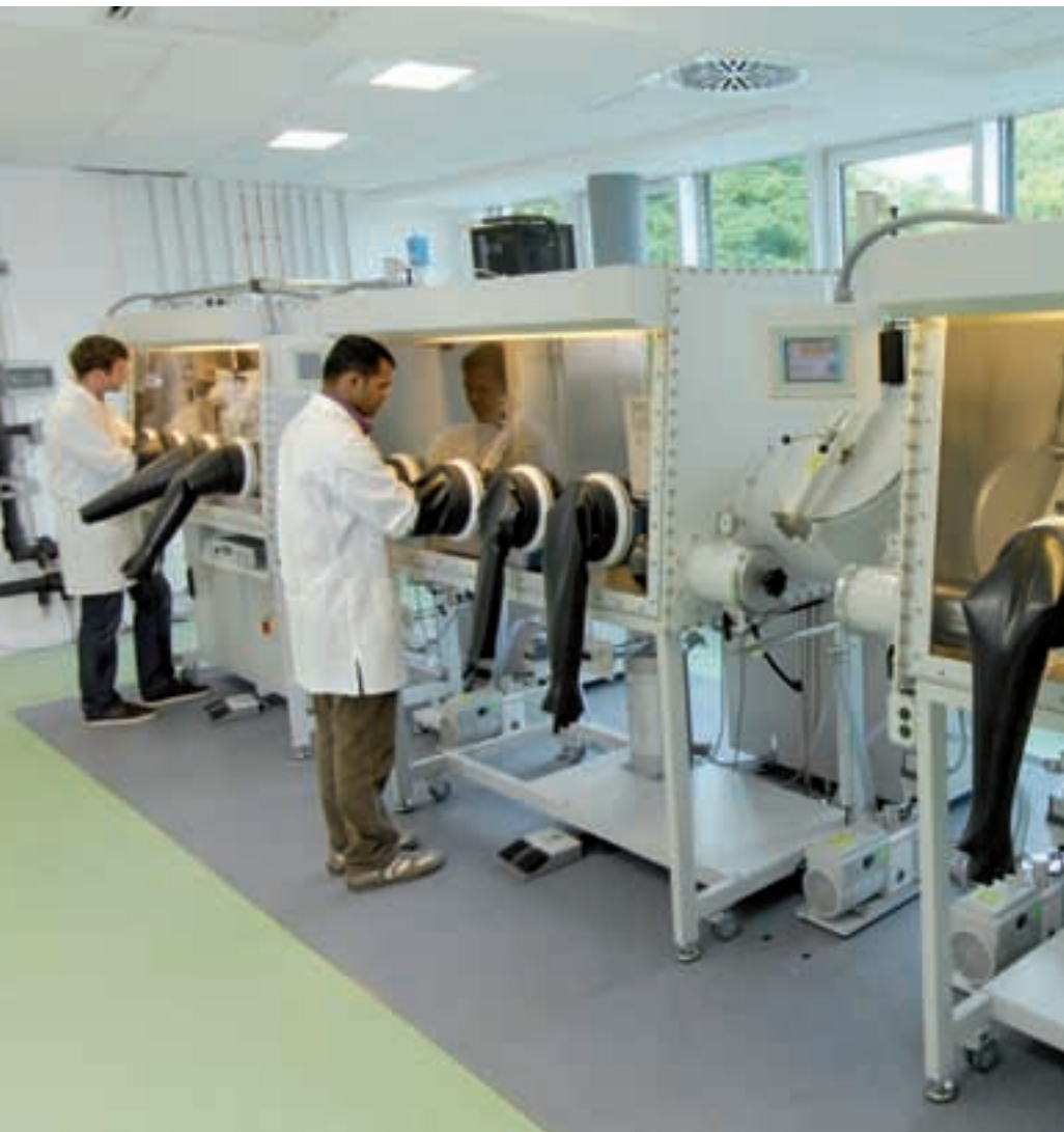
Herstellung prüfbarer Zellen unter Schutzgas (© Fraunhofer IFAM)
