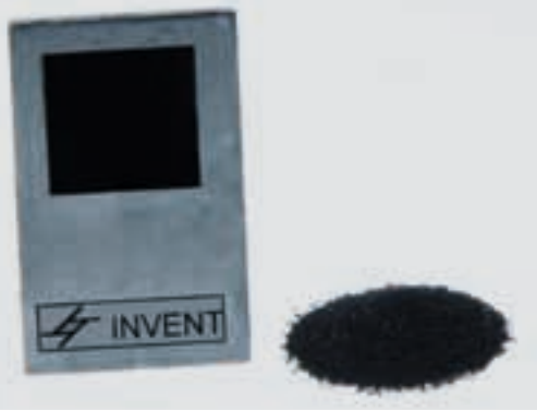
Pulverförmiges Rohmaterial sowie eine daraus hergestellte Platte mit teilweise modifizierter Oberfläche zur Absorptionssteigerung (© INVENT GmbH)
