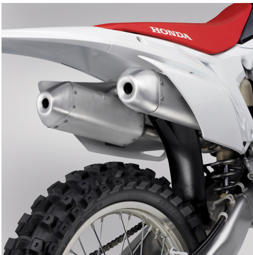
Neue Abgasanlage mit zwei Dämpfern.
