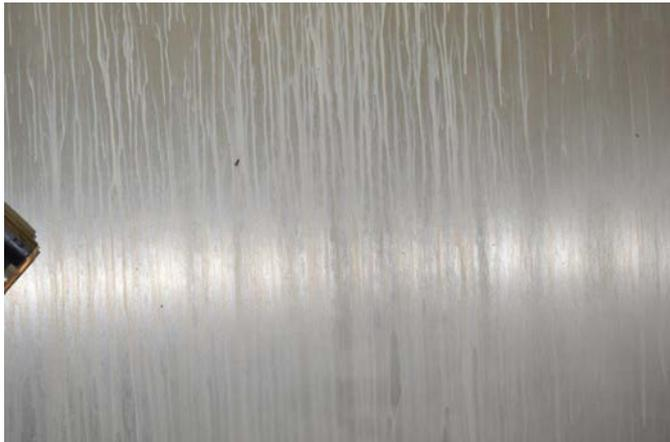
BU: Prallblech unter Verwendung des früher eingesetzten Kühlschmierstoffes. Das Ablaufvermögen ist sichtbar mangelhaft.
