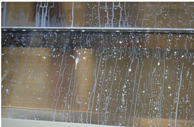
BU: Prallblech unter Verwendung des Hochleistungskühlschmierstoffes Zubora 65 H Ultra von Zeller+Gmelin: Das Ablaufvermögen ist deutlich besser. Die durchschnittlichen Standzeiten konnten auf bis zu 75 Wochen erhöht werden.
