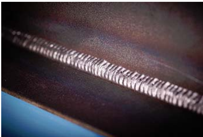
Abb. 6: T-Stoß, Werkstoff P265GH, einseitig geschweißt, Decklage
