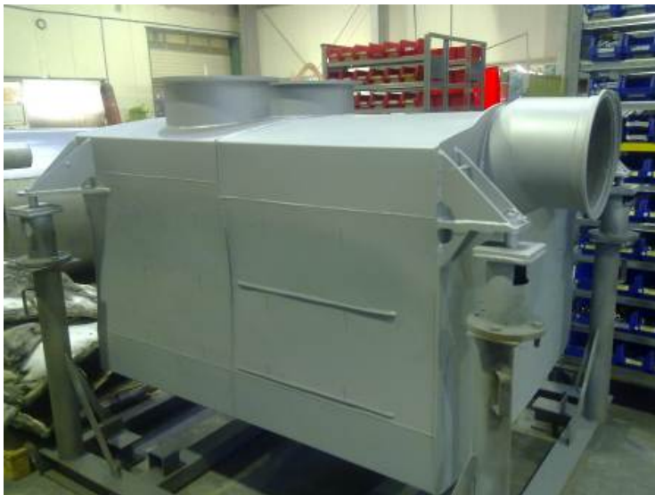
Abb. 4: Alle finalen Nähte sind nur von außen schweißbar. Mit coldArc® lassen sie sich sicher einseitig durchschweißen – als Vollanschluss, ohne Angriffspunkte für die gefürchtete Spaltkorrosion
