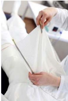
Textile Heizelemente bilden den Kern des entwickelten Patienten-Wärmesystems.
