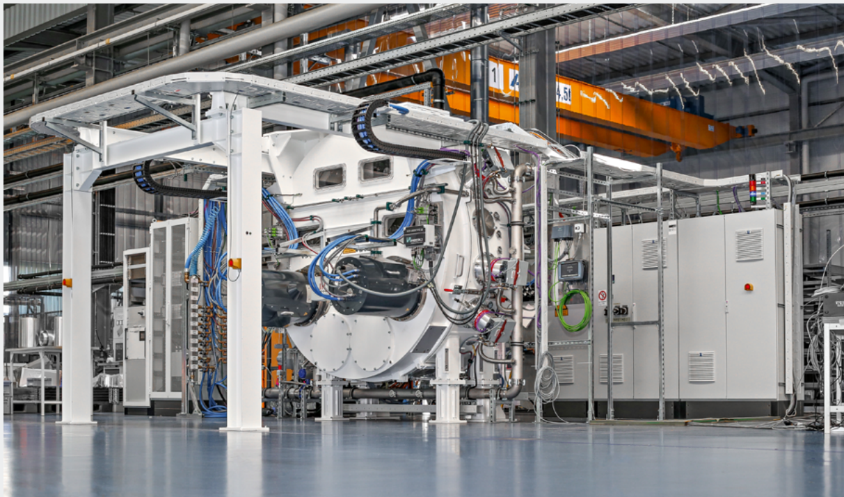
VON ARDENNE FOSA LabX 330 Glass - Beschichtungsanlage für flexibles Glas Bildrechte: © VON ARDENNE Corporate Archive
