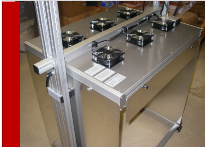
Abb. 5 STIR®-Modul zum Gelieren von Plastisol (Draufsicht)
