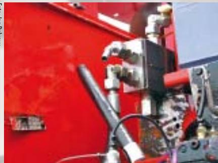
**UNFALLGEFAHR** durch unsachgemäß verpresste Schlauchleitungen: die Armatur riss unter dem hohen Betriebsdruck ab, und die Fassung durchschlug den Kotflügel eines Transporters – der Unfall hätte tödlich enden können.
