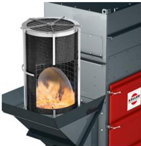
ProPipePlus zur flammenlosen Druckentlastung bei Metallstaubexplosionen: In der Mehrzahl der Anwendungen sind vorbeugende Exschutz-Maßnahmen wie Funkenvorabscheider nicht zuverlässig genug. Mit konstruktiven Schutzmaßnahmen sorgt Keller Lufttechnik vor und stellt sicher, dass im Ernstfall niemand verletzt wird.
