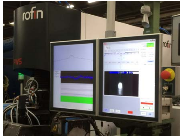
Abb. 4: Die neueste PWS Anlage mit Falldorf Nahtinspektor
