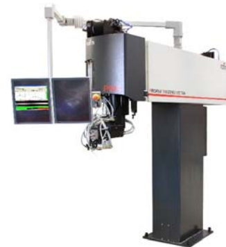
Abb. 5: ROFIN Profile Welding System PWS mit Doppelmonitor zur Überwachung des optionalen integrierten Nahtinspektors
