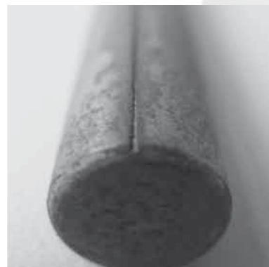
3) Beschichtung ohne Biozid Der abgebeizte Teststab zeigt nach einmonatiger Prüfdauer eine erweiterte Risstiefe von 150 bis 200 µm.
