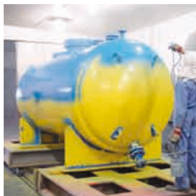
5) Trinkwassertank, Innen- und Außenbeschichtung
