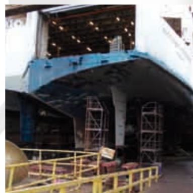
6) Ruder, Heck und Scheuerleiste, Außenbeschichtung. Foto: Scandlines
