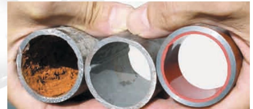
2) Rohrleitungssanierung nach dem Promotec-System; korrodierte, gereinigte und beschichtete Rohrleitungen
