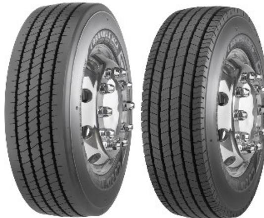
Die neue Reifenpalette umfasst den UrbanMax MCA für die Lenkachse, auch geeignet zur Rundumbereifung, sowie den UrbanMax MCD Traction für die Antriebsachse. Die neuen Reifen sind speziell für den Ganzjahreseinsatz bei Kommunalfahrzeugen entwickelt worden, die im Stadtverkehr zum Einsatz kommen. Hinsichtlich Geräuschanforderungen erfüllen sie schon heute die künftigen EU-Richtlinien.
