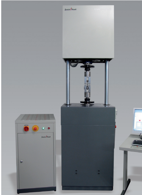
Hochfrequenzpulsator Amsler HFP 5100 mit Fmax 50 kN
