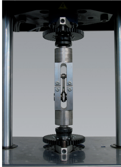
Ermüdungsprüfung an einem Pleuel
