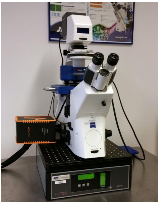
Der kombinierte Abberior STEDYCON / JPK NanoWizard®-Aufbau im neuen gemeinschaftlichen Demonstrationszentrum in Berlin.
