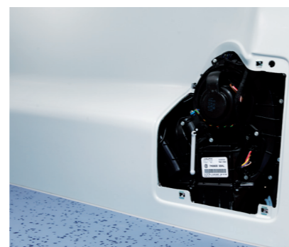
Nutzung der werkseitigen Klimaanlage
