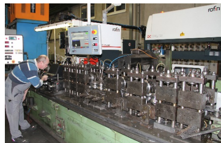
Bild 5: Das an einem Tragarm befestigte PWS Bedienfeld erlaubt eine einfache, übersichtliche und einheitliche Bedienung aller wichtigen Systemfunktionen
