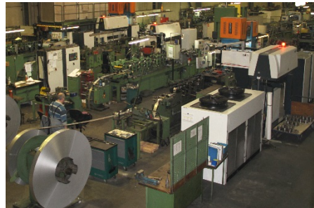
Bild 1: Drei CO 2 -Slab-Laser mit Profile Welding System von ROFIN ersetzen inzwischen die fünf alten WIG-Schweißanlagen bei Esta Rohr.
