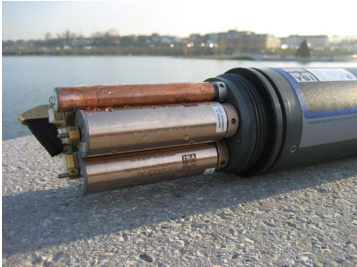
Abb. 3: Multiparametersonde
