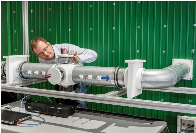
Aktives Schallschutzmodul für einen Lüftungskanal.
