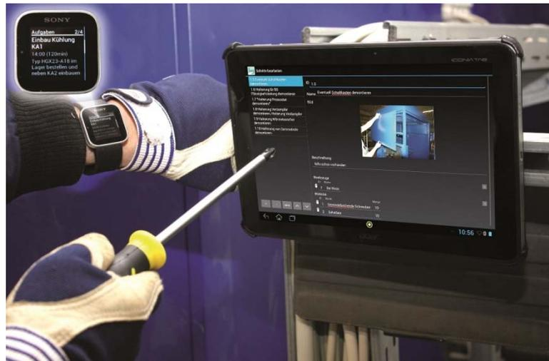
Bild: [M] Tablet-PCs, Smartphones und Smartwatches können den Monteur bei seinen Aufgaben unterstützen. Über mobile Displays sind wichtige Informationen direkt am Arbeitsplatz verfügbar und der Arbeiter kann sich Schritt für Schritt durch den Montageprozess führen lassen. Wie das funktioniert, zeigen die Forscher des Fraunhofer IGD vom 7. bis 11. April auf der diesjährigen Hannover Messe (Halle 5, Stand D14).
