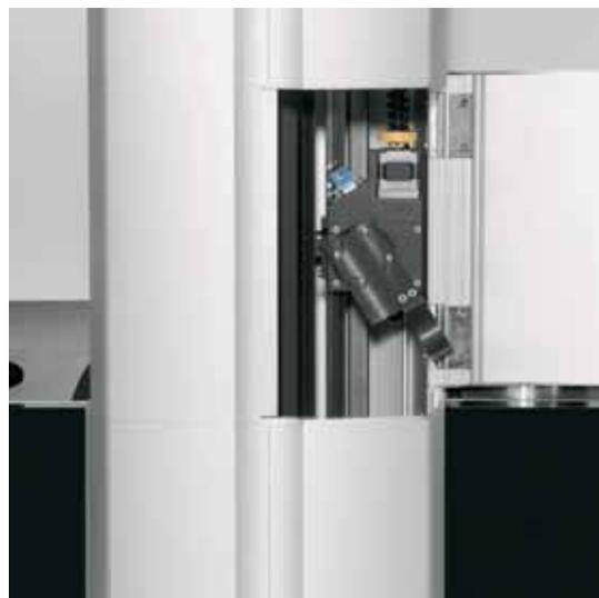
Laser Particle Sizer analysette 22 zur Trocken-Dispergierung
