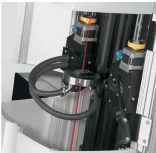
Laser Particle Sizer analysette 22 zur Nass-Dispergierung
