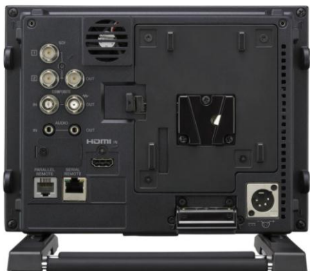
Bild 3: Beide Monitore (hier: PVM-741) stecken im gleichen Gehäuse und sind mit zwei 3G-SDI-Eingängen ausgerüstet.
