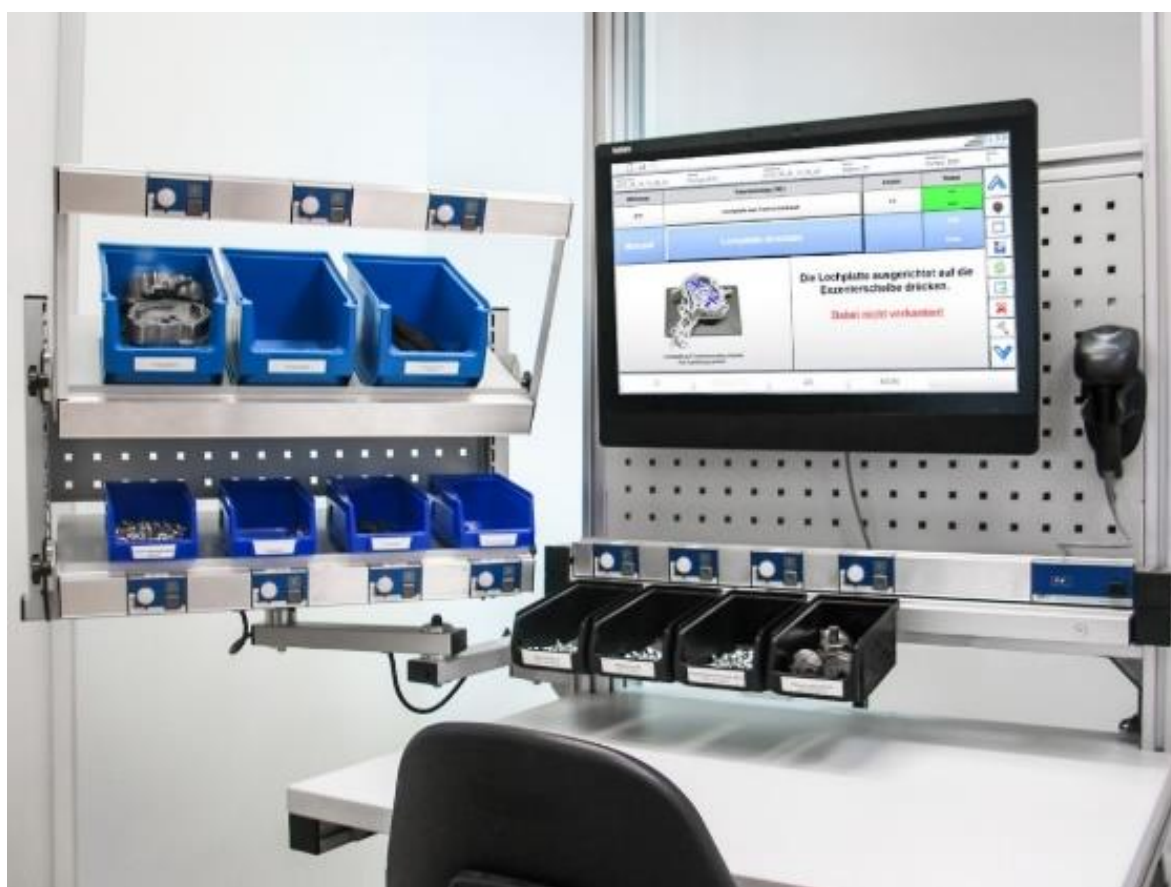
Abbildung 5: Beispiel einer Kompaktanlage von Armbruster Engineering mit Scanner, Pick to Light-Anbindung und visuellem Werkerführungssystem.
