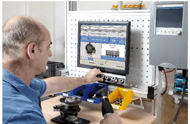
Abbildung 1: Visuelle Werkerführung inklusive Schrauberanbindung mit dem ELAM-System von Armbruster Engineering.
