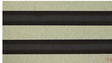
Abb. 5: Materialbearbeitung mit PowerLine Pico mit 97% Überlapp bei 1500 mm/s und 600 kHz
