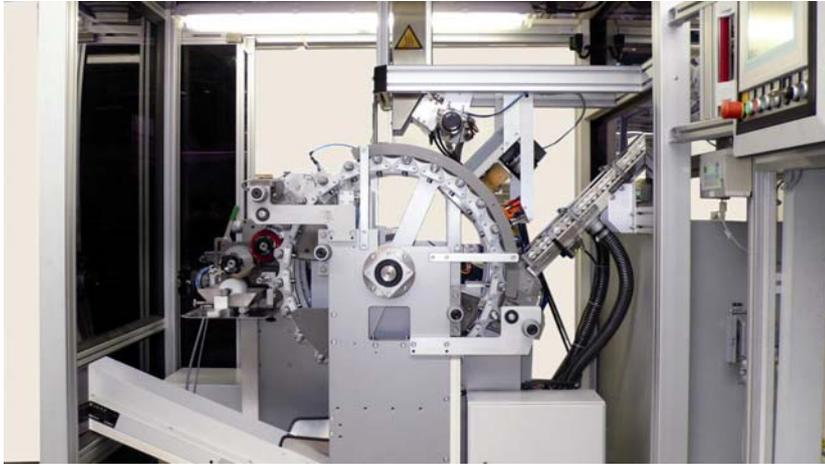
Teilansicht „HSC“-High Speed Circular für zylindrische Teile (Patent angemeldet)
