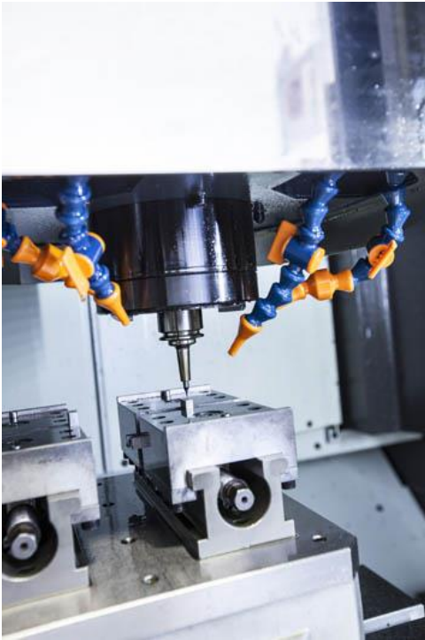
Bild Nr. 15-03 TT_S+B-Fraesen.jpg Vor allem die harten Materialien stellen große Herausforderungen an die Maschinen. In der HSC-Bearbeitung mit der YMC 430 sind die kleinen Stufen, die strategiebedingt beim Fräsen entstehen, deutlich präziser.
