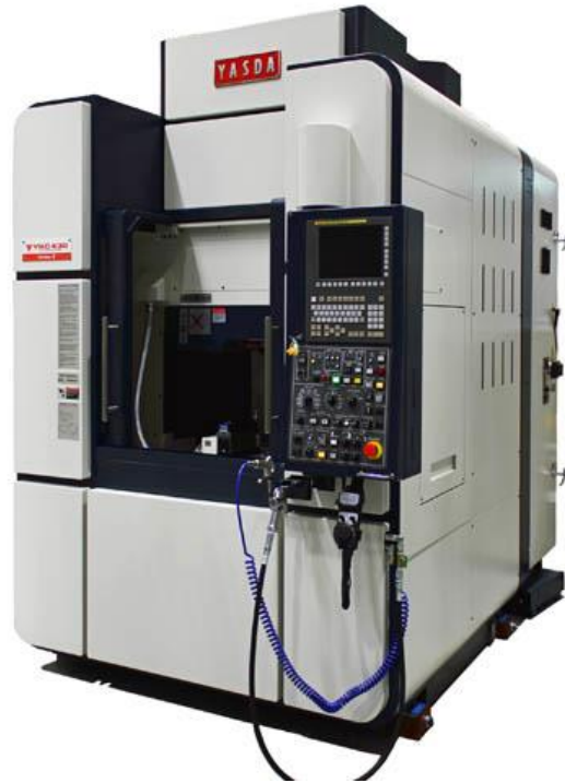
Bild Nr. 15-04 TT_S+B-YASDA-YMC430.jpg Hohe Steifigkeit: Das Yasda Micro Center YMC430, das TECNO.team vertreibt, ist kompakt und wiegt dennoch rund 8 t. Die Führungen sind handgeschabt.
