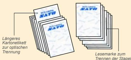
Der Drucker kann einzelne Stapelteile separieren, indem er entweder das erste Etikett der Reihe größer als die anderen ausgibt oder auf das erste Etikett der Reihe eine Lesemarke aufrägt.
