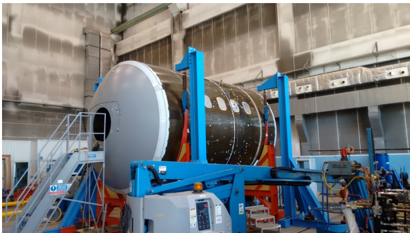
Bodentest im Labor: Ein spezieller Messaufbau erfasst die durch Aufblasen simulierte zyklische Innendruckbelastung an einem Flugzeugumpf. Foto: Leonardo
