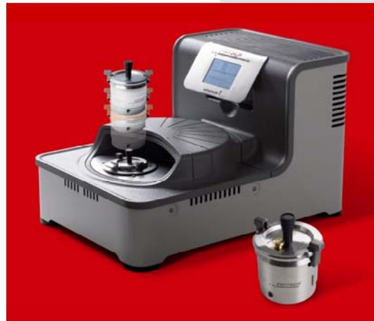
Planeten-Kugelmühen zeichnen sich dadurch aus, dass die Mahlbecher auf der Sonnenscheibe der Mühle verspannt werden. Dies limitiert die maximal mögliche Drehzahl, denn ab einer bestimmten Grenz-Drehzahl werden die auf die Becher wirkenden Zentrifugalkräfte so hoch, dass die Verspannung die Becher nicht mehr halten kann. Schäden an der Mühle und den Bechern sind die Folge.
