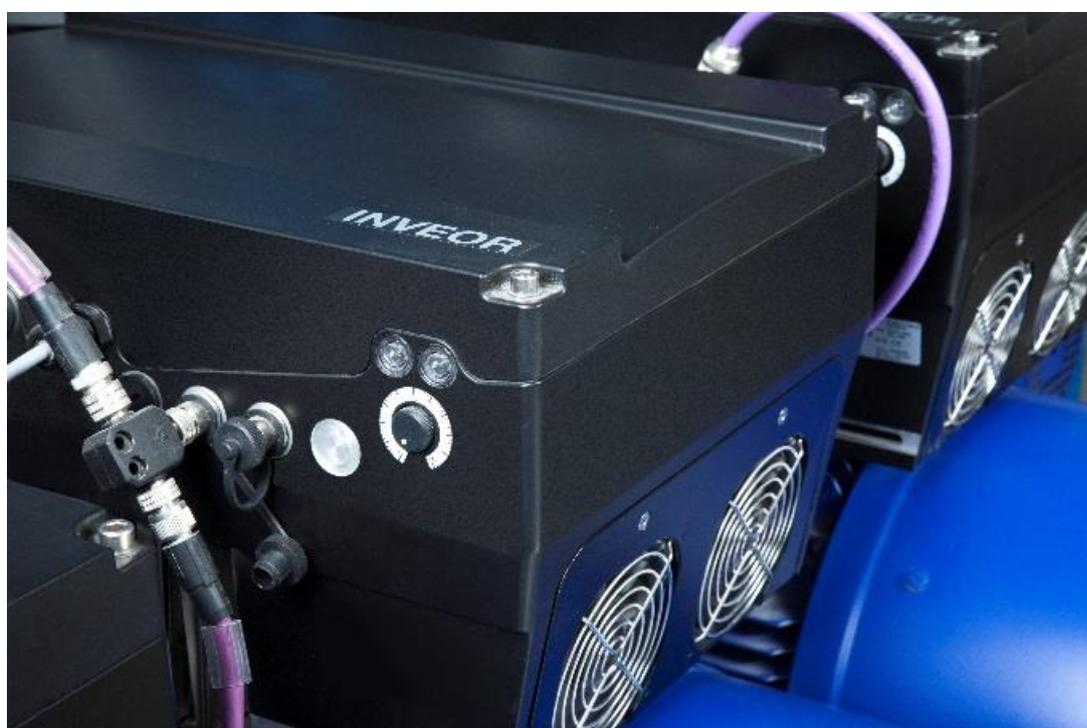
Bild1: Über die Feldbusschnittstelle vernetzte Antriebsregler in der Applikation
