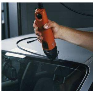
Bildunterschrift: "Anvulkanisierte Scheibenrahmen sind kein Problem für das L-Messer. PUR-Verklebung und Rahmen werden in einem Arbeitsgang durchtrennt."
