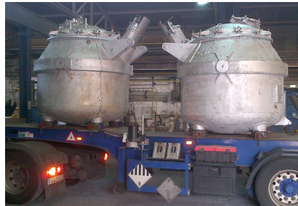
Auflieger mit Transportwarmhaltetiegeln für Flüssigaluminium und angebaute SMITH-Sensorik (in der Mitte zwischen den beiden Behältnissen) bei der Aleris Recycling GmbH (Quelle: Aleris/ISL)
