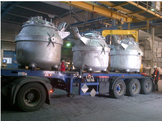
Auflieger mit Transportwarmhaltetiegeln für Flüssigaluminium und angebaute SMITH-Sensorik (in der Mitte zwischen den beiden Behältnissen) bei der Aleris Recycling GmbH (Quelle: Aleris/ISL)
