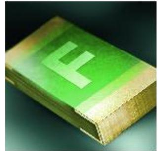
Die Chip-Sicherungen von SCHURTER sind in vielen Nennstrom-Ausführungen von 50 mA bis 25 A bei Nennspannung von bis zu 125 VAC/VDC erhältlich. Je nach Ausführung und Nennspannung wird ein Ausschaltvermögen von bis zu 600 A erreicht. Diese beachtlich hohen Werte und die Variantenvielfalt dieser Chip-Sicherungen ermöglichen eine Vielzahl von Anwendungen. Besonders geeignet sind die Chip-Sicherungen für mobile und batteriebetriebene Geräte in der Sensortechnik und Industrieelektronik.
