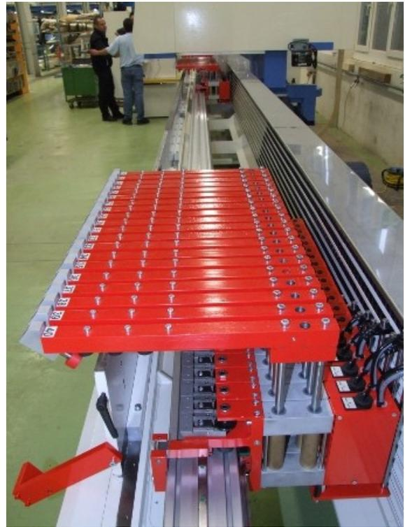
Mit der Software NC-luX werden 40 Spanner angesteuert.
