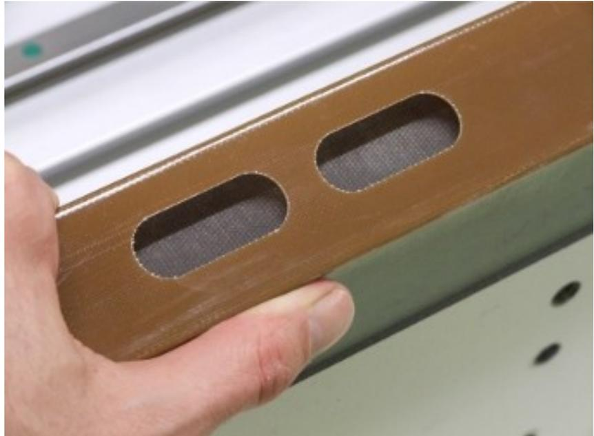
Exakte Position, sauberes Fräsbild: Durch die Langlöcher des Isolationsmaterials werden die Generatoren mit Luft oder Gas gekühlt. Das Material hält Temperaturen bis 180 Grad aus und muss im Dauerbetrieb bis zu 40 Jahre halten.
