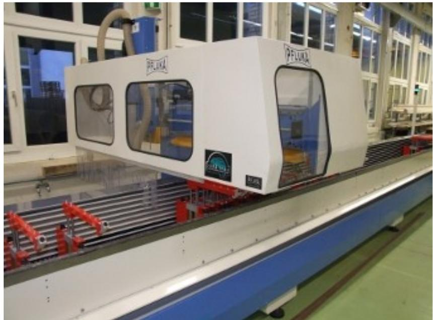
Die Ummantelung erlaubt freie Sicht auf die Arbeitsflächen und schützt den Maschinenbediener.
