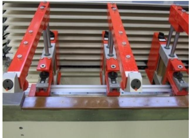
Geöffnete Spanner nach der Bearbeitung: Das dünne Epoxidharzprofil kann von der schmalen Auflage genommen werden.
