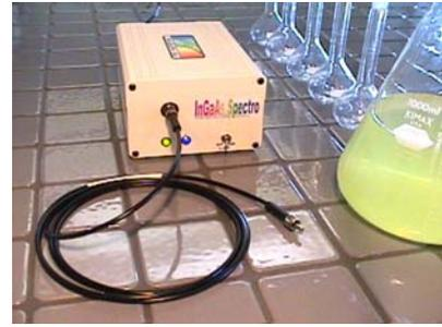
*Ein hochauflösendes Array-Spektrometer auch für den rauen Einsatzbereich.*
