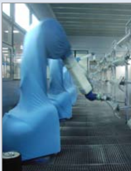
Grafik: Roboterlackieranlage für Kfz-Außenteile
